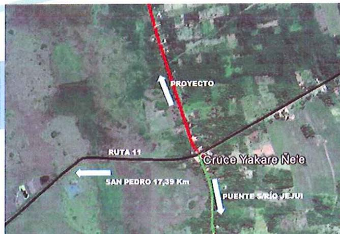
La construcción y rehabilitación de este tramo contempla movimiento de suelo, obras de drenaje, paquete estructural (Pavimento tipo Carpeta Asfáltica), puente de hormigón y obras complementarias. Longitud: 88,67 Km.
