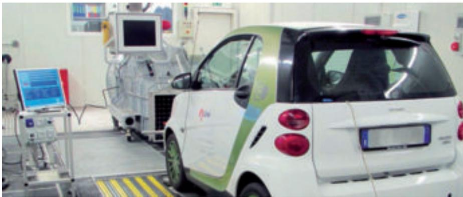
Ensayo de un vehículo eléctrico. El Centro Común de Investigación ha modernizado sus instalaciones para estudiar el comportamiento estático y dinámico de las redes eléctricas ante fenómenos como la integración de las energías renovables, los vehículos eléctricos o la dispersión de los recursos energéticos y su almacenamiento
